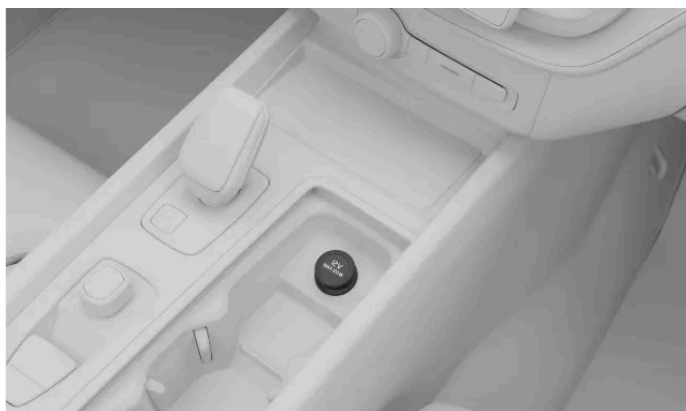
Gniazdo elektryczne 12 V na konsoli między fotelami
