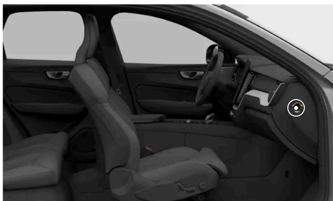
Położenie przełącznika poduszki powietrznej pasażera
