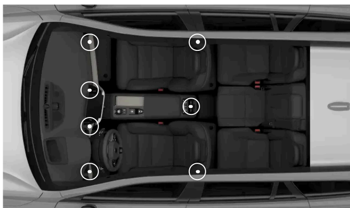
Rozmieszczenie regulowanych nawiewów
