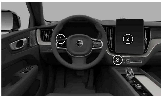
Rozmieszczenie elementów sterujących światłami zewnętrznymi
