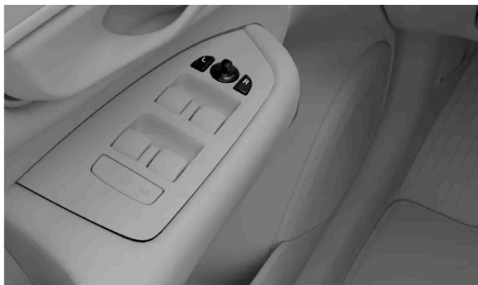
Elementy sterujące regulacją lusterek bocznych
