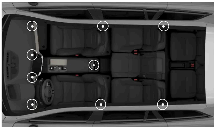
Rozmieszczenie regulowanych nawiewów
