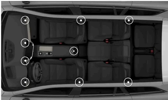
Rozmieszczenie regulowanych nawiewów
