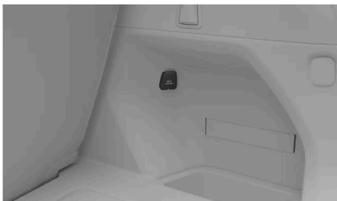
Gniazdo elektryczne 12 V po prawej stronie bagażnika
