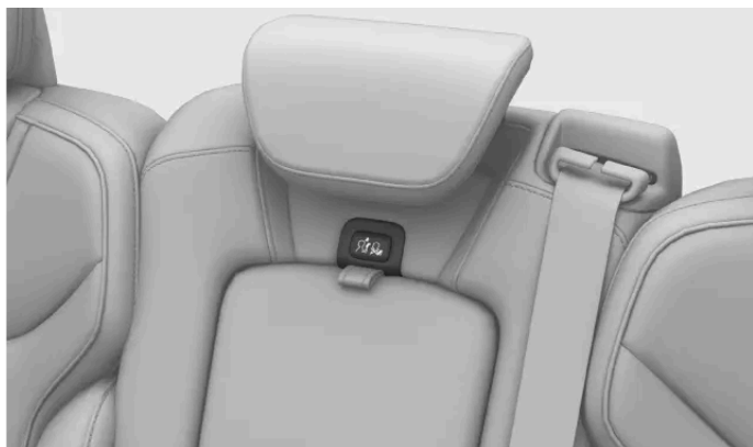
Przycisk blokowania na środkowym zagłówku
