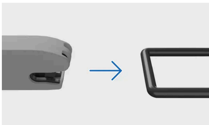
Mocowanie do punktu mocowania ISOFIX
