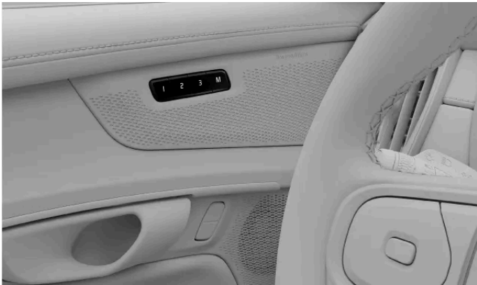
Położenie przycisków zaprogramowanych ustawień fotela
