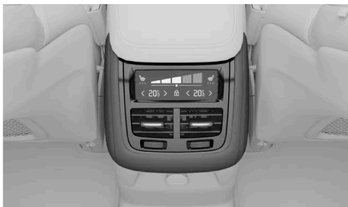
Elementy sterujące klimatyzacją na konsoli między fotelami
