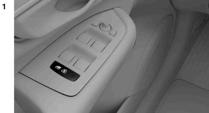
Położenie przycisku blokady tylnych drzwi na panelu drzwi
