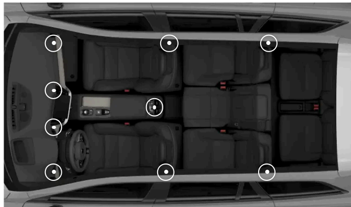
Rozmieszczenie regulowanych nawiewów
