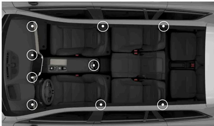
Rozmieszczenie regulowanych nawiewów
