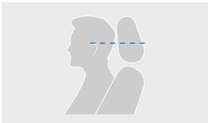
Prawidłowy poziom zagłówka
