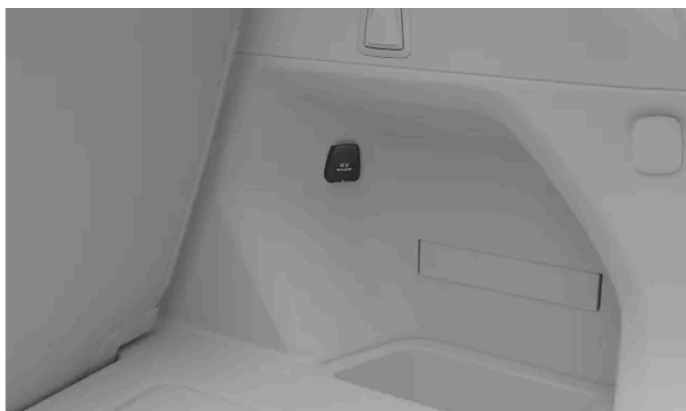
Gniazdo elektryczne 12 V po prawej stronie bagażnika
