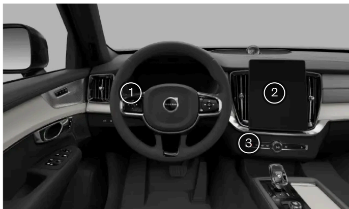
Rozmieszczenie elementów sterujących światłami zewnętrznymi
