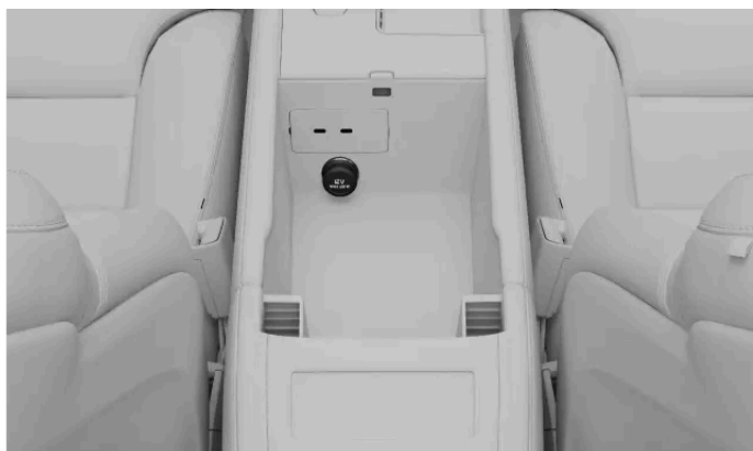
Gniazdo elektryczne 12 V na konsoli między fotelami
