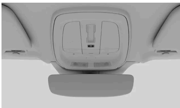
Przycisk włączania pełnego oświetlenia na konsoli sufitowej
