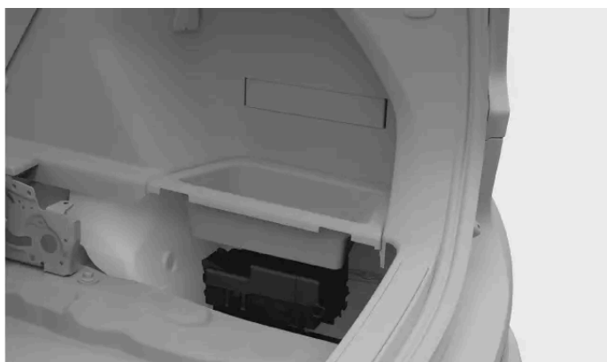
Położenie skrzynki bezpieczników
