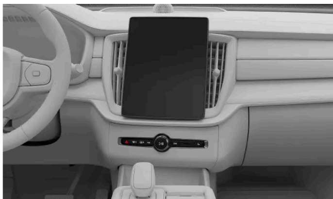
Przyciski ogrzewania szyb na wyświetlaczu centralnym i na panelu przycisków pod wyświetlaczem centralnym
