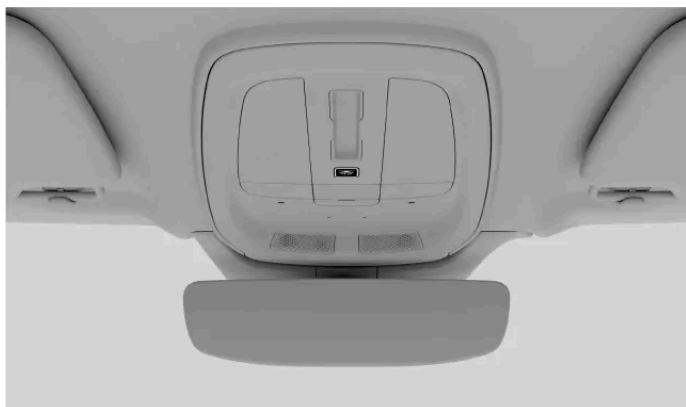
Todas as luzes interiores no botão da consola do teto
