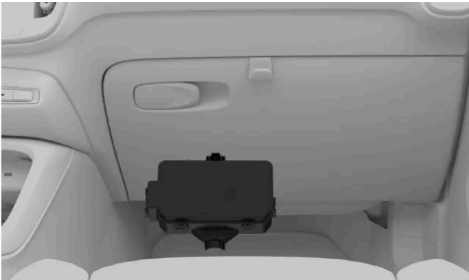
Localização da caixa de fusíveis
