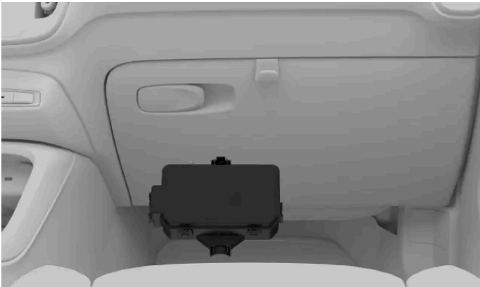
Localização da caixa de fusíveis
