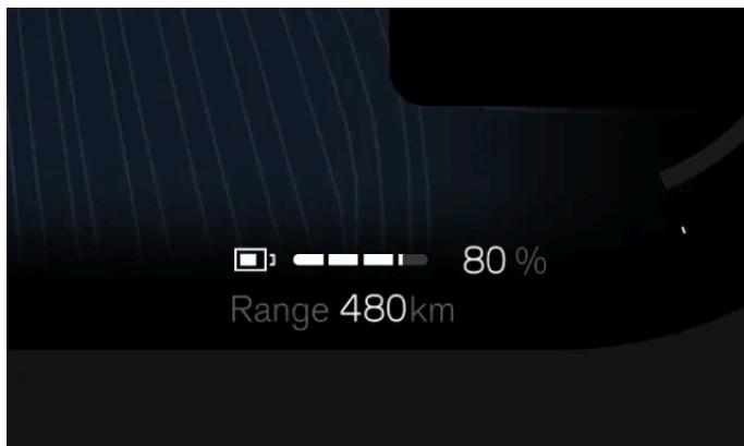
A sua autonomia está relacionada principalmente com o nível da bateria do seu automóvel e o seu estilo de condução, mas as condições externas também são um fator a ter em conta. O nível da bateria e autonomia esperada são apresentados no mostrador do condutor. A autonomia esperada é calculada com base no seu padrão de condução, atual e histórico.
