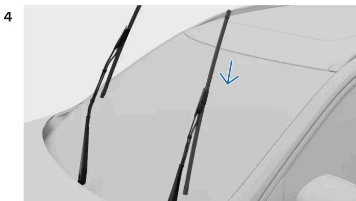
Assegure-se de que a escova do lado do condutor é mais comprida do que a do lado do passageiro. Deslize a escova do limpador de para-brisas no braço do limpador de para-brisas. Assegure-se de que o pino no braço do limpador de para-brisas entra no orifício da escova do limpador de para-brisas. Empurre a escova no braço do limpador de para-brisas até escutar um estalido.
