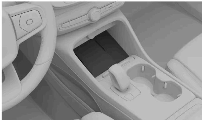
Para utilizar o carregador sem fios, o seu dispositivo tem de estar certificado com a norma de carregamento sem fios Qi. Assegure-se ainda de que o carregamento sem fios está ativado no dispositivo [\[1\]](#) e no carregador. Pode ativar o carregador no mostrador central.
