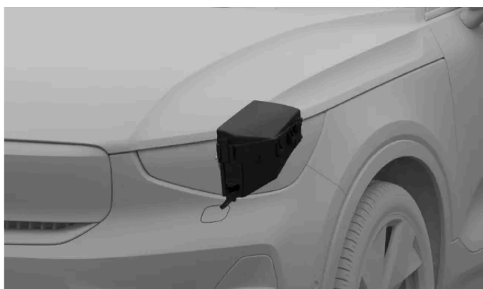
Localização da caixa de fusíveis
