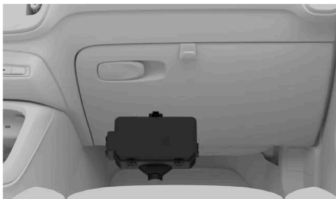
Localização da caixa de fusíveis
