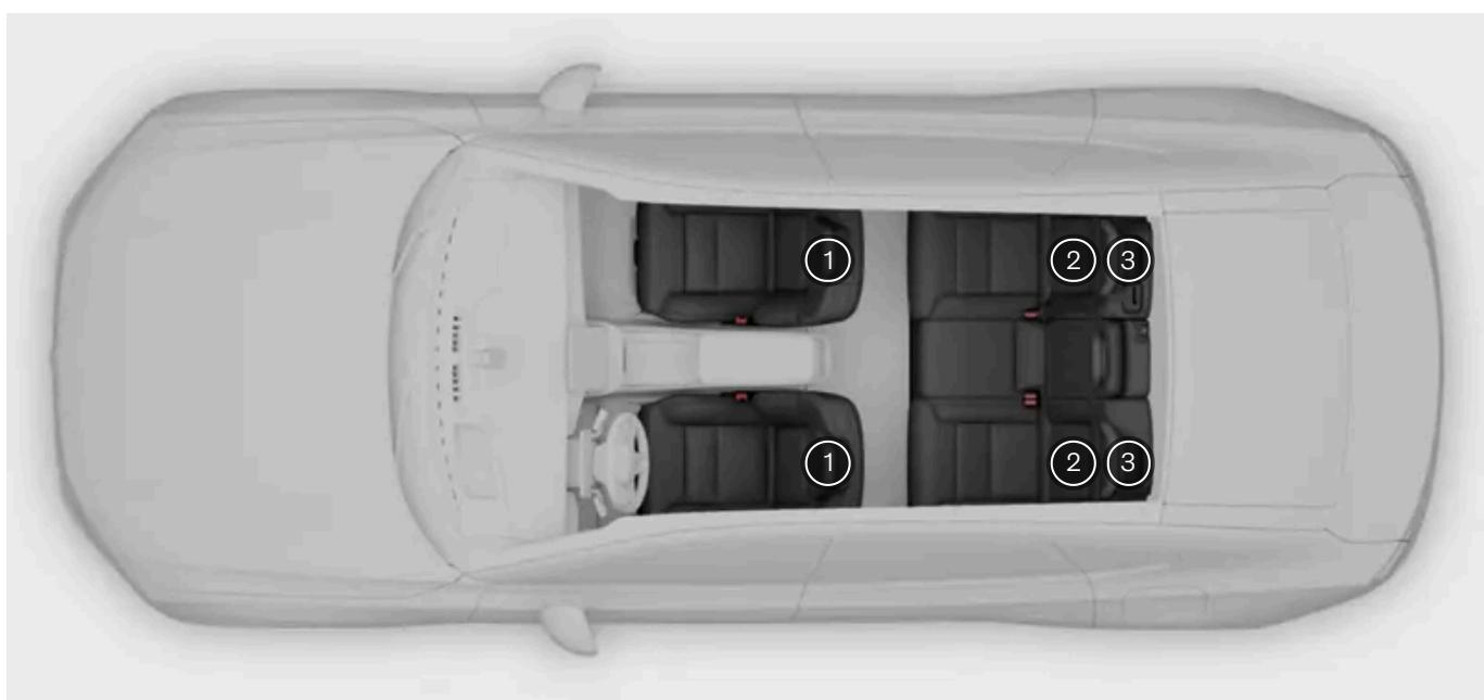
**[1]** Pontos de fixação do tirante inferiores nas calhas do piso dos bancos dianteiros **[1]**
