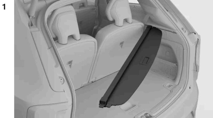
Coloque a extremidade da cobertura de carga na reentrância na ranhura de um dos lados do porta-bagagens. A reentrância está realçada com uma linha de marcação. Assegure-se de que a extremidade da cobertura de carga fica alinhada com a linha de marcação.
