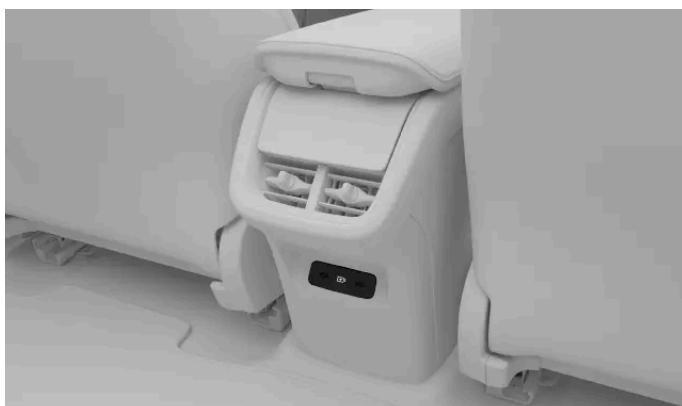
Também existem duas portas USB<sup>[1]</sup> na parte traseira da consola de túnel.
