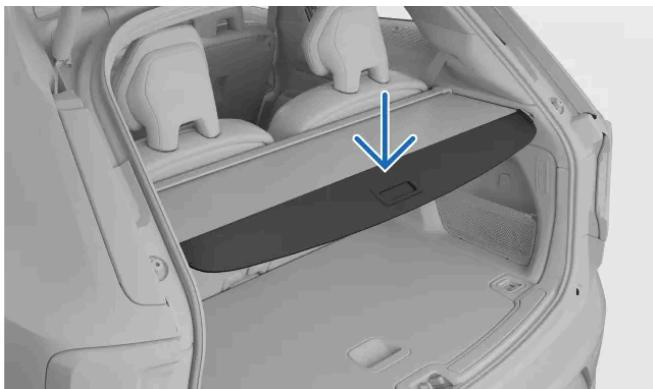
Incline a margem exterior da cobertura de carga para baixo de modo a bloquear na sua posição nas ranhuras.
