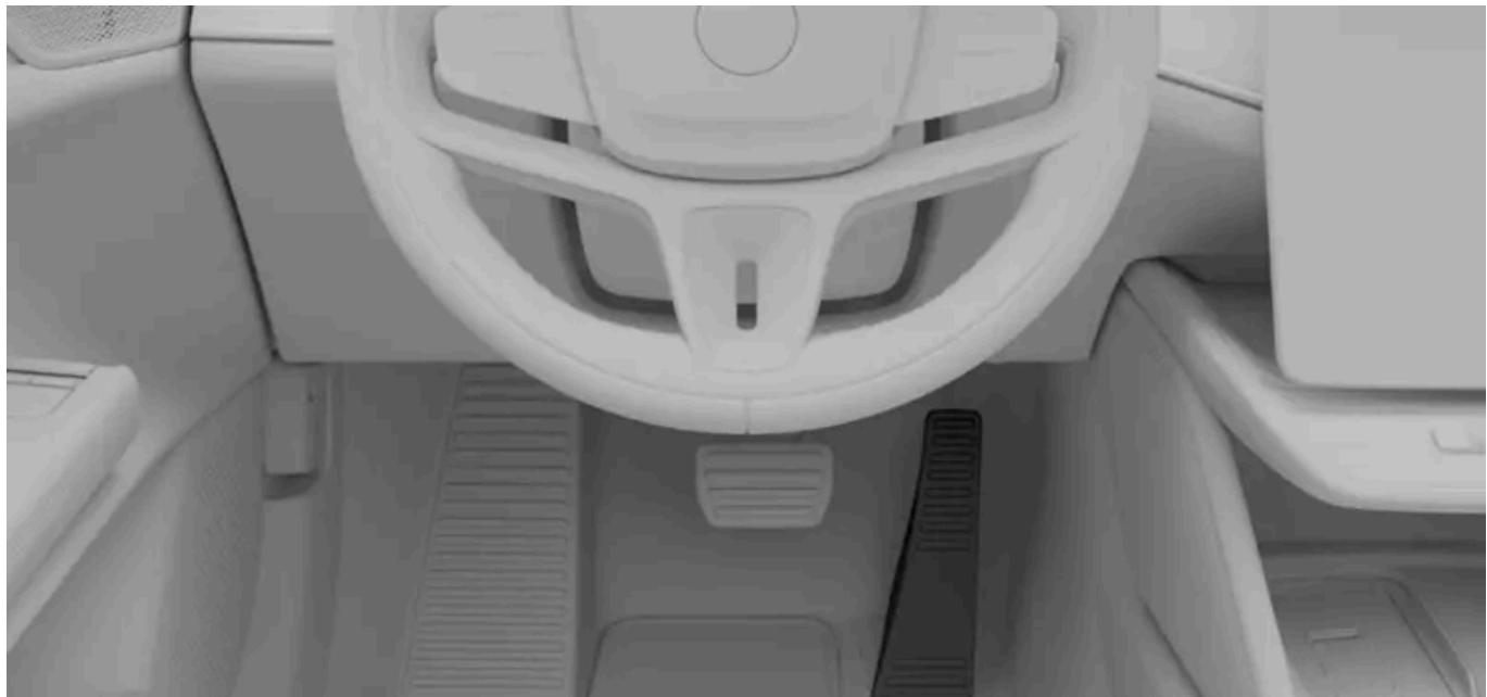
O comportamento da travagem muda com a utilização do pedal do acelerador. Quando pressiona o acelerador, o automóvel acelera normalmente, mas ao libertar o pedal ativa a travagem. Quanto mais libertar o pedal, maior ação de travagem obtém. Ao libertar completamente o acelerador, o automóvel acabará por parar.
