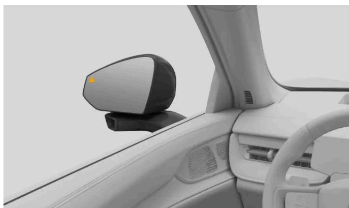
Quando o automóvel deteta trânsito na iminência de passar perto dos lados do automóvel, aparece uma luz no retrovisor lateral. Se começar a abrir a porta no lado do trânsito detetado, o alerta intensifica-se. Um som de alerta pode ocorrer juntamente com alertas visuais, dependendo da urgência do aviso.
