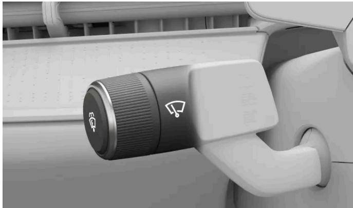
Pode comandar o lava e limpa-para-brisas utilizando o anel rotativo e o botão na alavanca do lado esquerdo do volante.
