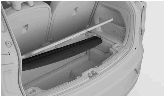
Coloque a extremidade direita da cobertura de carga no suporte da cobertura de carga, que se encontra no lado direito do compartimento de carga.
