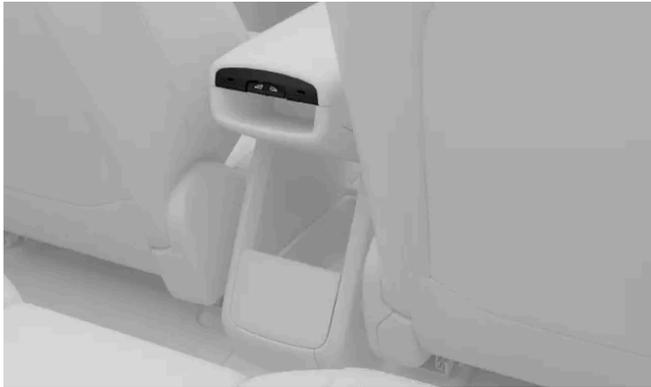
Pode acionar os vidros traseiros a partir dos bancos traseiros utilizando os interruptores na extremidade traseira do descanso de braço central.
