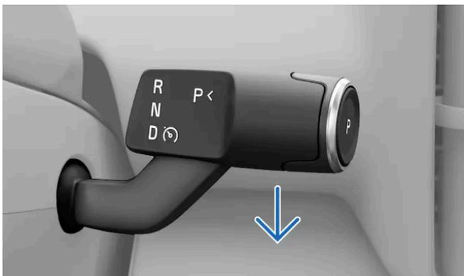
Quando adequado, puxe completamente para baixo a alavanca do lado direito do volante.
