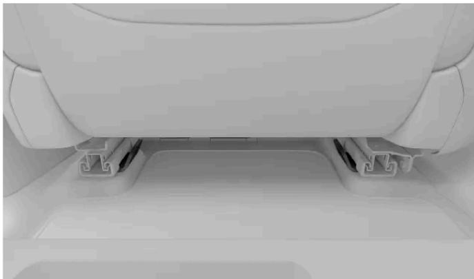
Os pontos de fixação do tirante inferior para os bancos traseiros podem ser encontrados na parte de trás das calhas do piso dos bancos à frente.
