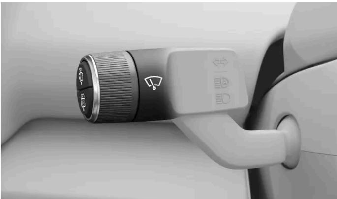
Pode comandar o lava e limpa-para-brisas utilizando o anel rotativo e os botões na alavanca do lado esquerdo do volante.
