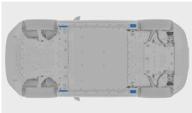
Existem dois pontos de elevação em cada lado do automóvel.
