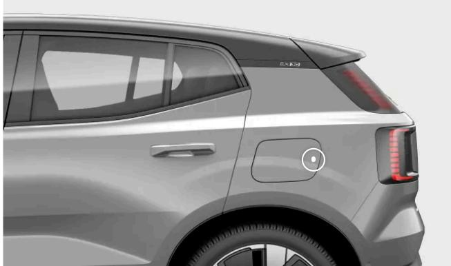
**2** Retire quaisquer coberturas da entrada e do conector do cabo.
