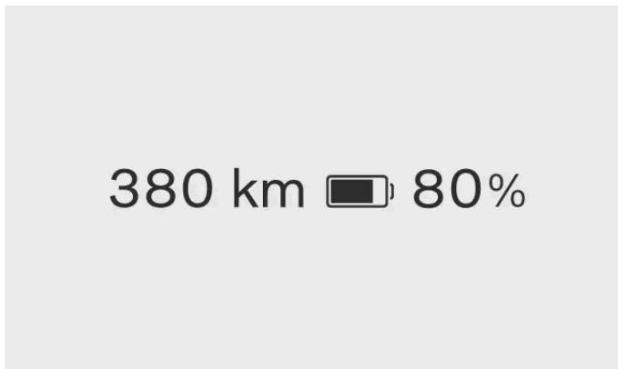
O medidor da bateria está sempre visível na área de informação do condutor. A cor do ícone da bateria muda consoante o nível da restante carga na bateria.
