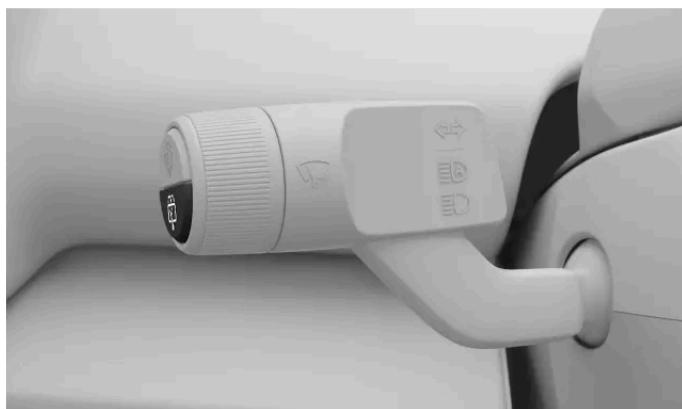
Pode comandar o limpa-vidro traseiro através do botão inferior da alavanca do lado esquerdo do volante.
