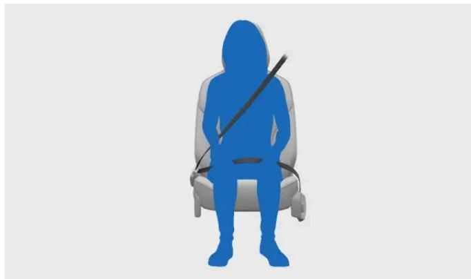
O cinto de segurança bloqueia-se para atuar com sistema de retenção de segurança em determinadas situações. Estas incluem um puxão forte e súbito do cinto, a condução agressiva do automóvel e a presença do automóvel numa inclinação acentuada.
