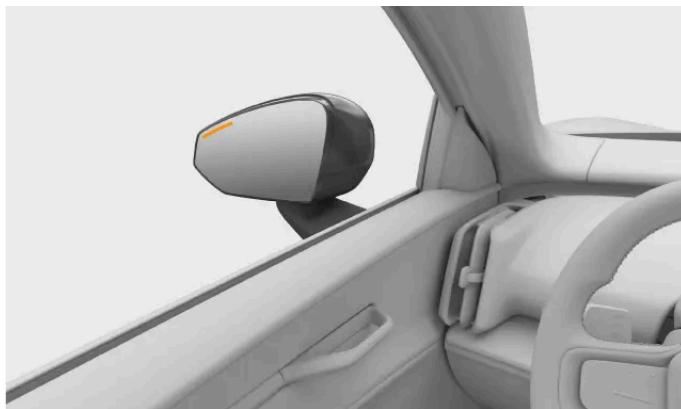
Quando o automóvel deteta trânsito na iminência de passar perto dos lados do automóvel, aparece uma luz no retrovisor lateral acompanhada por uma notificação no mostrador. Se começar a abrir a porta no lado do trânsito detetado, o alerta intensifica-se. Um som de alerta pode ocorrer juntamente com alertas visuais, dependendo da urgência do aviso.
