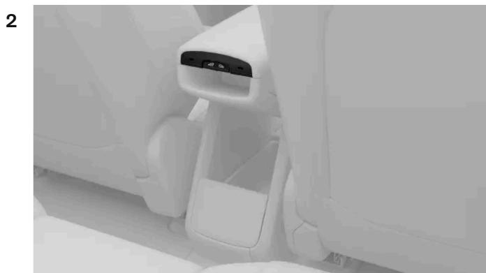
Pode acionar os vidros traseiros a partir dos bancos traseiros utilizando os interruptores na extremidade traseira do descanso de braço central.
