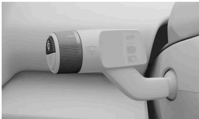
Existem diferentes modos de funcionamento do limpa-para-brisa dianteiro, que podem ser ativados utilizando a alavanca do lado esquerdo. Os modos são:
