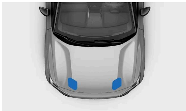
Pressione com ambas as mãos na margem dianteira da tampa do capô. Assegure-se de que o capô encaixa nos fechos em simultâneo. Mantenha a margem dianteira plana à medida que fecha.
