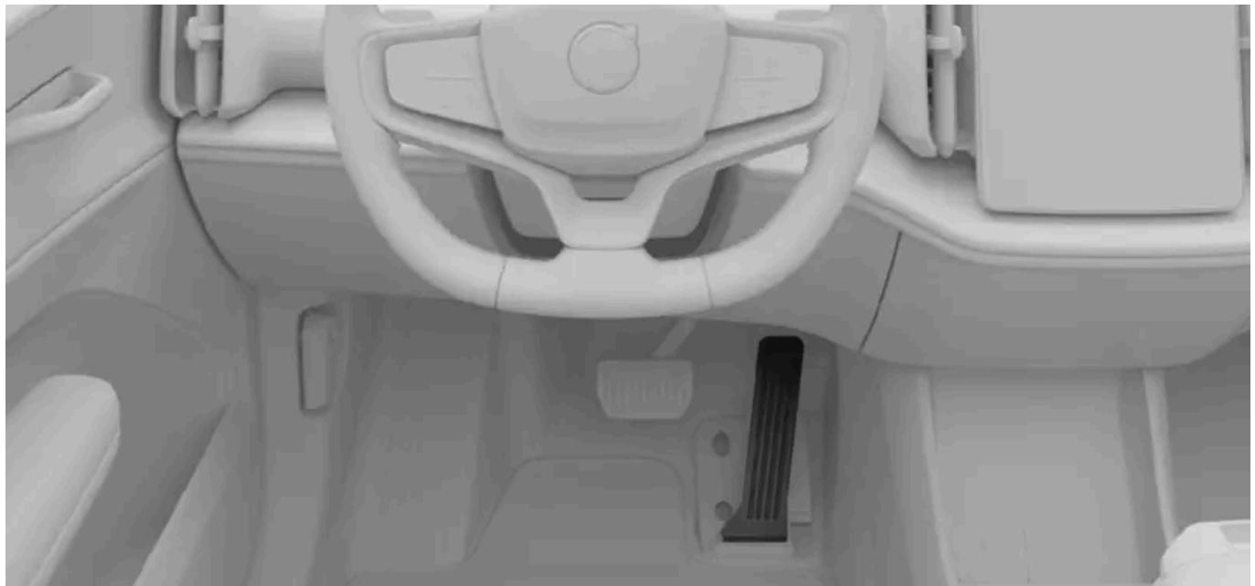
O comportamento da travagem muda com a utilização do pedal do acelerador. Quando pressiona o acelerador, o automóvel acelera normalmente, mas ao libertar o pedal ativa a travagem. Quanto mais libertar o pedal, maior ação de travagem obtém.
