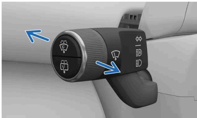
Pode deslocar a alavanca do lado esquerdo para a frente ou para trás para alternar entre as diferentes opções dos máximos. A alavanca recua sempre por ação de mola para a posição neutra.
