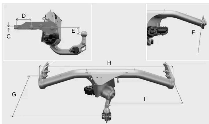
Medidas, pontos de fixação em milímetros (polegadas)
