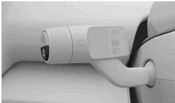
Pode comandar o limpador traseiro através do botão inferior da alavanca do lado esquerdo do volante.
