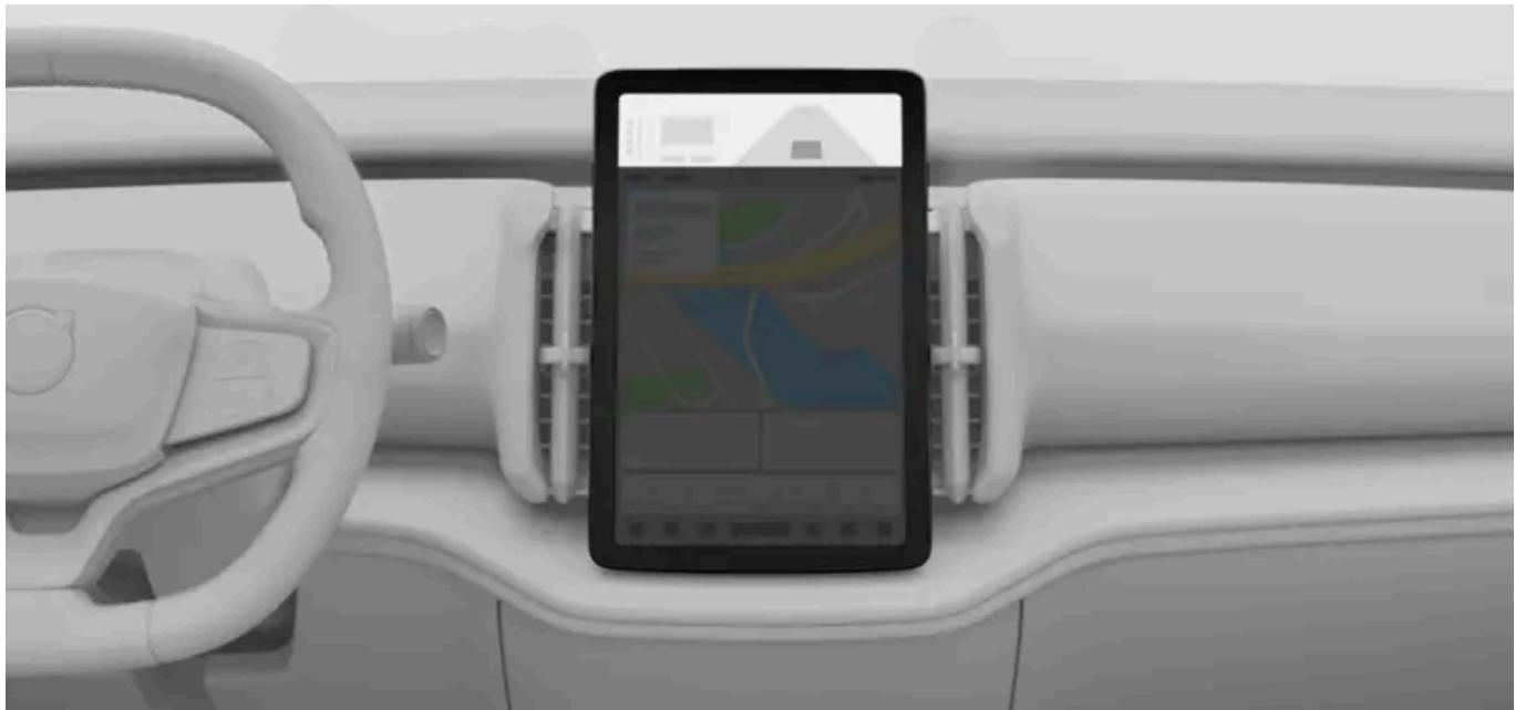
A área de informação do condutor não é sensível ao toque e, por isso, não pode interagir com a mesma através da superfície do mostrador. Pode interagir com a área de informação do condutor utilizando os botões do volante.
