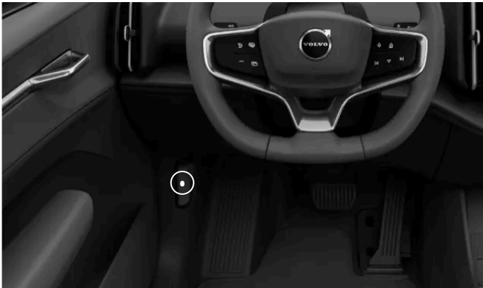
A alavanca interior vista do banco do condutor.
