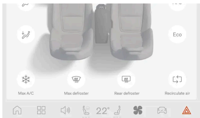
A localização do botão das luzes de sinalização de perigo no mostrador
