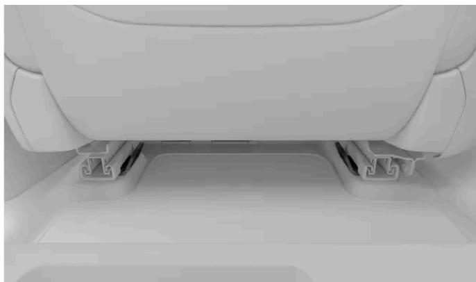
Os pontos de fixação do tirante inferior para os bancos traseiros podem ser encontrados na parte de trás das calhas do piso dos bancos à frente.
