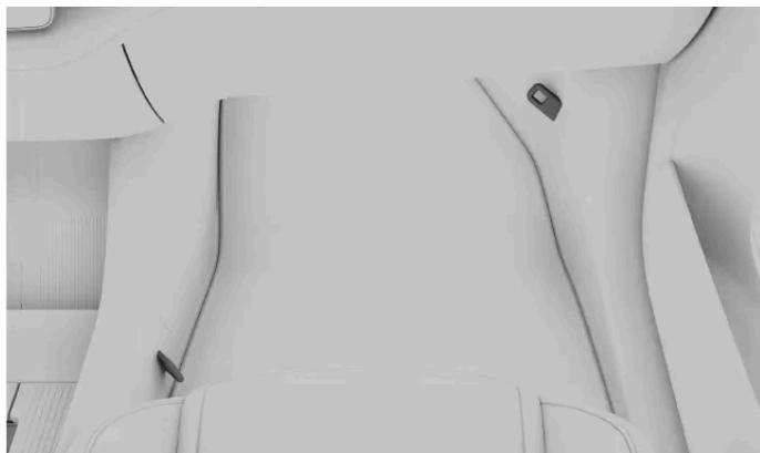
Com o acessório do tirante inferior [1], os pontos de fixação do banco do passageiro dianteiro encontram-se nos lados da zona dos és do banco.
