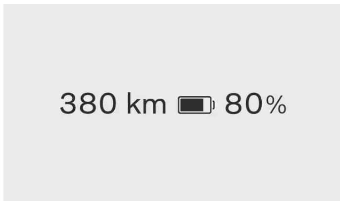
O medidor da bateria está sempre visível na área de informação do condutor. A cor do símbolo da bateria muda consoante o nível da carga restante na bateria.
