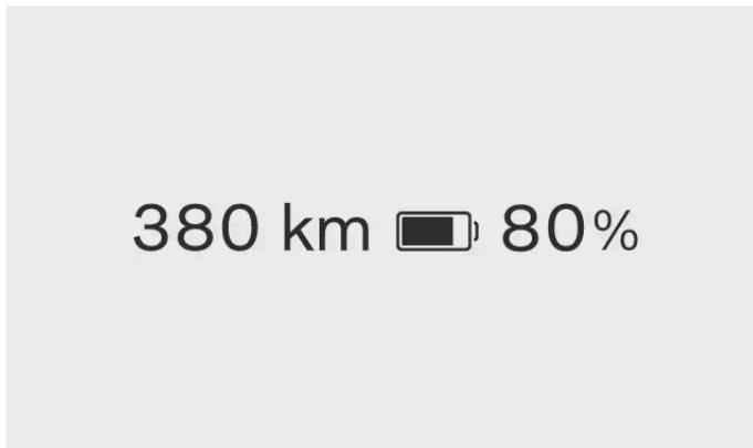
A sua autonomia está relacionada principalmente com o nível da bateria do seu automóvel e o seu estilo de condução, mas as condições externas também são um fator a ter em conta. O nível da bateria e a autonomia esperada são apresentados na área de informações do condutor. A autonomia esperada indica-lhe até onde pode conduzir com o nível da bateria presente. Este é calculado com base no seu padrão de condução, tanto presente como histórico, e nas condições de condução em tempo real.
