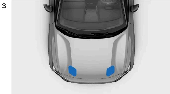
Pressione com ambas as mãos na margem dianteira da tampa do capô. Assegure-se de que o capô encaixa nos fechos em simultâneo. Mantenha a margem dianteira plana à medida que fecha.
