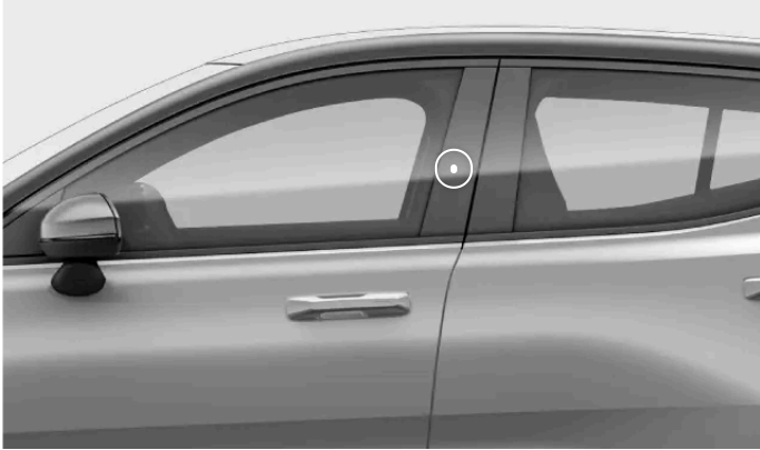
Local de leitura da chave no pilar da porta
