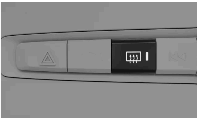
Botão de degelo traseiro no painel de botões abaixo do mostrador central
