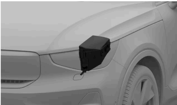
Localização da caixa de fusíveis
