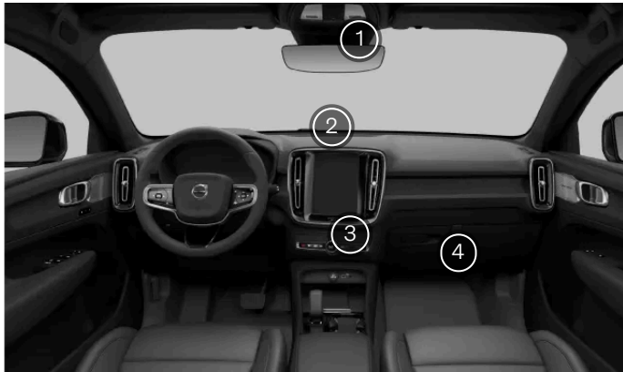
Os sensores da climatização interior
