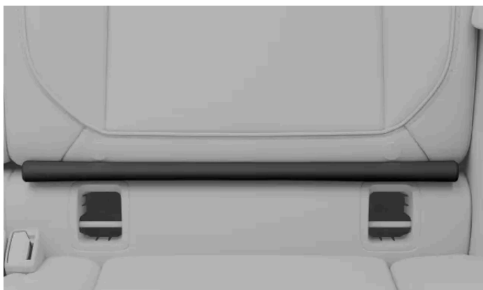
A aba ISOFIX dobrada, colocada no espaço acima dos pontos de fixação
