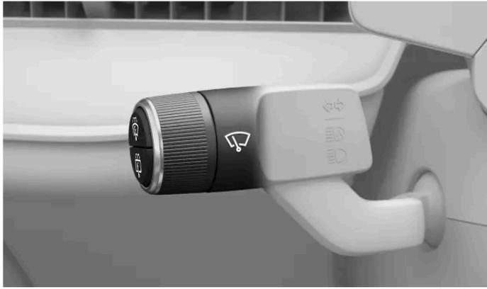
Pode comandar o lava e limpa-para-brisas utilizando o anel rotativo e os botões na alavanca do lado esquerdo do volante.
