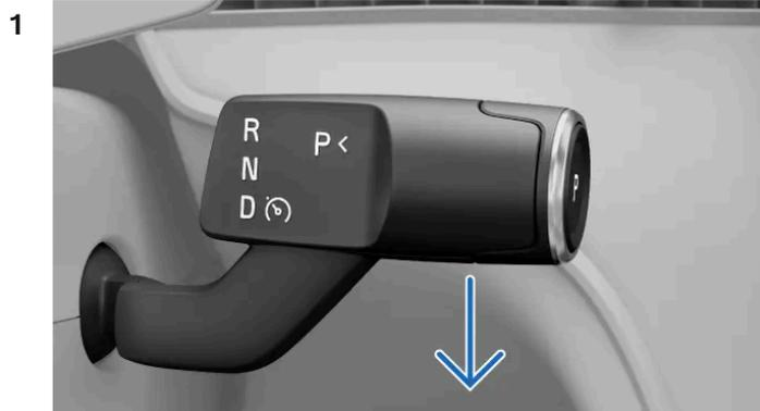
Quando adequado, puxe completamente para baixo a alavanca do lado direito do volante.
