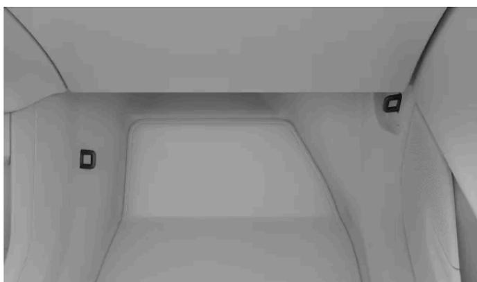
Com o acessório do tirante inferior<sup>[1]</sup>, os pontos de fixação do banco do passageiro dianteiro encontram-se nos lados da zona dos pés do banco.
