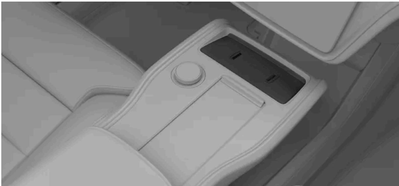
Para utilizar o carregador sem fios, o seu dispositivo tem de estar certificado com a norma de carregamento sem fios Qi. Assegure-se ainda de que o carregamento sem fios está ativado no dispositivo<sup>[1]</sup> e no carregador. Pode ativar o carregador no mostrador central.
