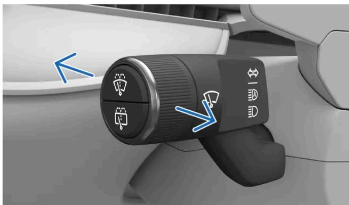
Pode deslocar a alavanca do lado esquerdo para a frente ou para trás para alternar entre as diferentes opções de máximos. A alavanca recua sempre por ação de mola para a posição neutra.
