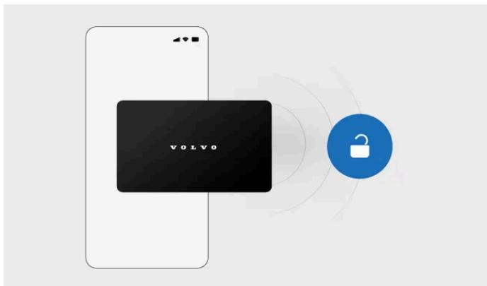
Ao configurar uma chave digital no seu dispositivo, ela funciona da mesma forma que as suas outras chaves. Se o seu dispositivo tiver a funcionalidade UWB <sup>[1]</sup>, o automóvel consegue detetar a chave digital à distância. Se o seu dispositivo não tiver a funcionalidade UWB, a chave digital funciona como um cartão-chave.
