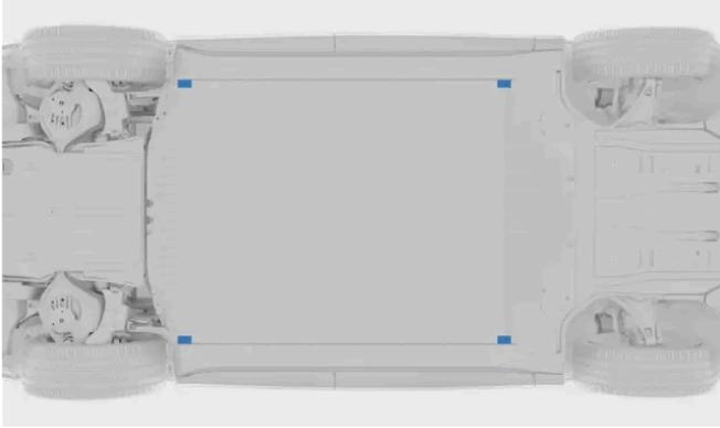
Existem dois pontos de elevação em cada lado do automóvel.
