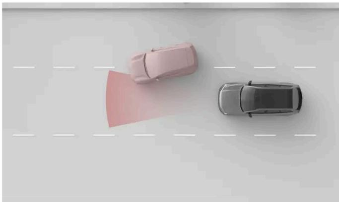
A zona de deteção do radar dianteiro tem uma largura limitada. Caso o seu trajeto seja cortado por outro veículo, a deteção pode ocorrer relativamente tarde, resultando numa resposta súbita do seu automóvel.
