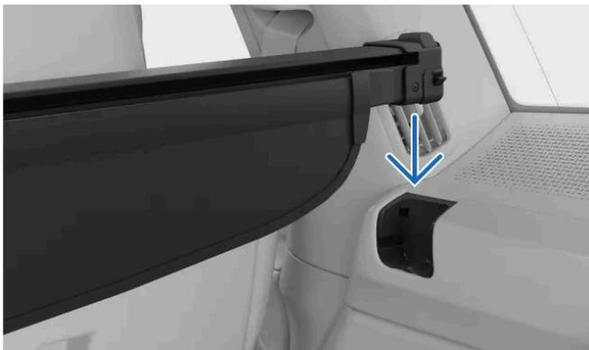
Empurre a cobertura de carga nas reentrâncias até ambos os lados da cobertura de carga encaixarem. Assegure-se de que os fechos estão posicionados com as marcas vermelhas ocultas.
