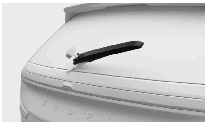
Segure no centro do braço do limpa-vidro e levante-o afastando-o do vidro traseiro. Pode sentir alguma resistência a meio do trajeto – esta é a posição de bloqueio. Tem de puxar o braço do limpa-vidro para além da posição de bloqueio para que este não caia de volta sobre o vidro traseiro.
