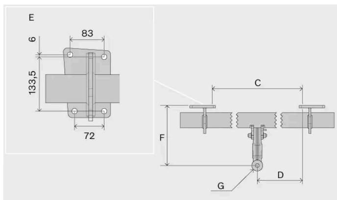
Dimensões, pontos de fixação em milímetros (polegadas)
