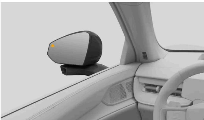
Quando um veículo é detetado ou se aproxima do seu ponto morto, aparece uma luz no retrovisor lateral.
