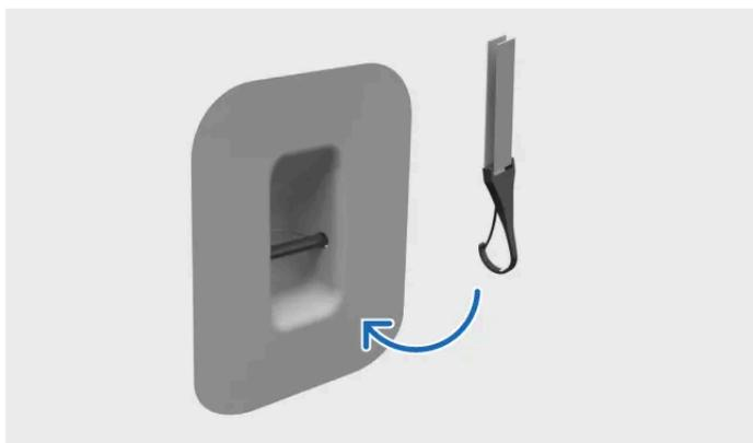
Fixação do tirante no ponto de fixação do tirante superior
