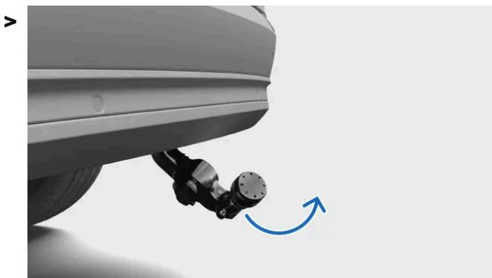
O engate de reboque é instalado. O símbolo no botão de instalação vai piscando à medida que o engate de reboque se abre.
