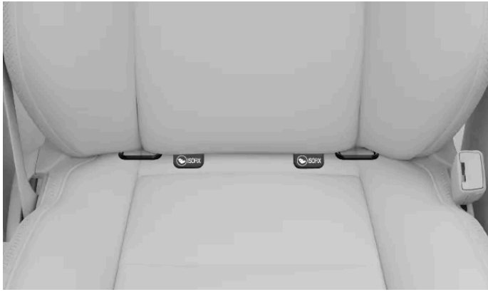
Localização dos pontos de fixação ISOFIX no banco do passageiro dianteiro
