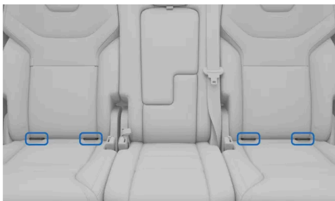
Localização dos pontos de fixação ISOFIX nos bancos da segunda fila
