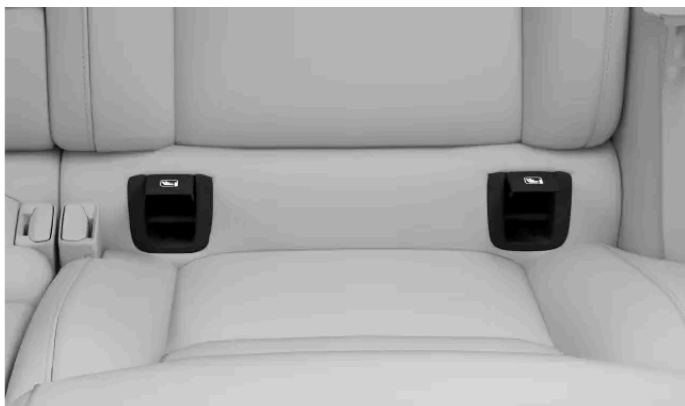
Localização dos pontos de fixação ISOFIX nos bancos laterais traseiros
