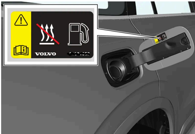
Autocolante de aviso na tampa do depósito de combustível.
