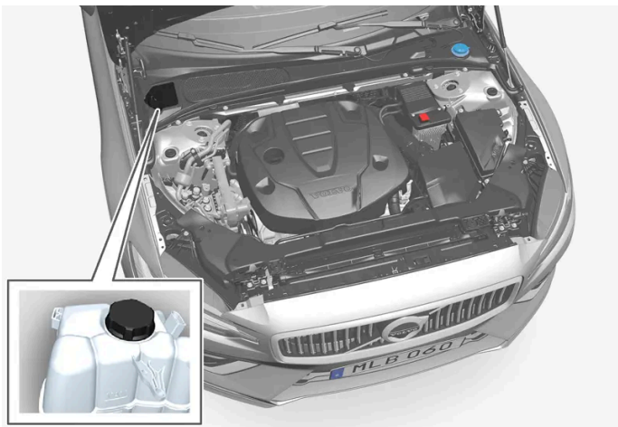
Tanque de expansão para o sistema de arrefecimento
