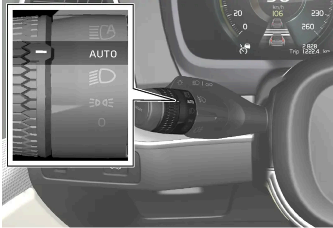
Anel rotativo da alavanca do volante na posição AUTO .
