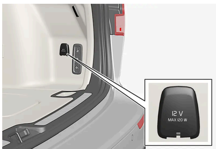
Tomada eléctrica 12 V no compartimento da bagagem/carga*.
