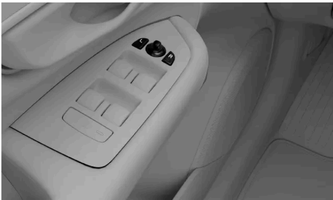
Comandos para ajuste dos retrovisores laterais
