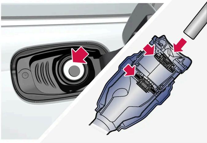
Antes de iniciar o abastecimento é importante colocar o bico da bomba para além das duas tampas com abertura do tubo de enchimento.
