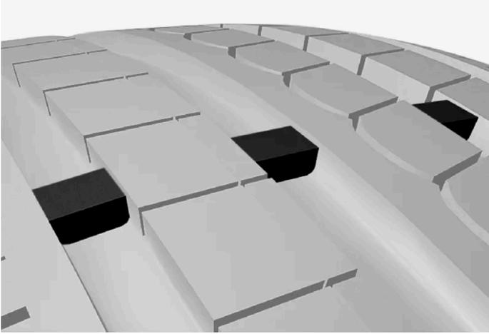
O indicador de desgaste é uma pequena protuberância que atravessa os sulcos do pneu. No lado do pneu aparecem as letras TWI (Tread Wear Indicator). Quando a profundidade de sulco estiver reduzida a 1,6 mm (1/16 tum), o rasto do pneu fica nivelado com os indicadores de desgaste. Nesta situação substitua logo que possível por pneus novos. Lembre-se que os pneus com pouca profundidade de sulco têm uma aderência muito reduzida com chuva e neve.
