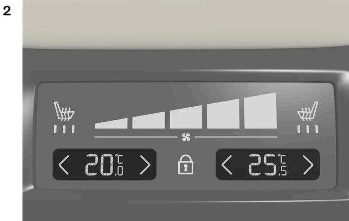
Comando da temperatura no painel de climatização traseiro na consola de túnel.
