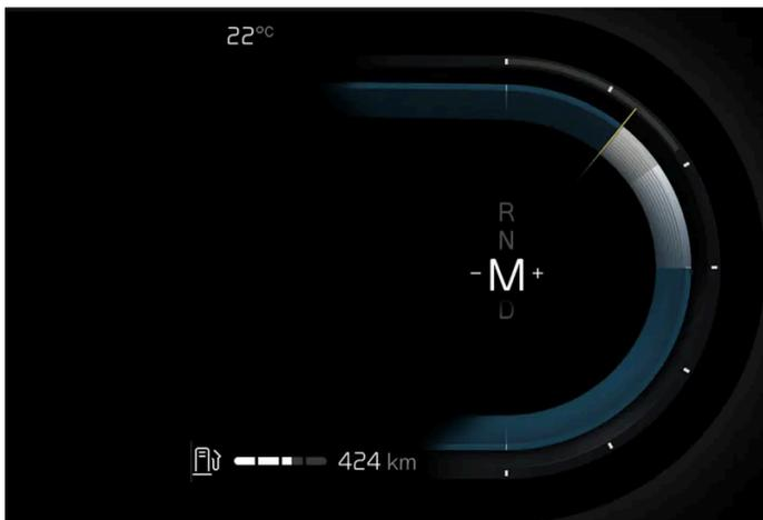
Com a posição M é possível proceder manualmente às mudanças. O motor trava quando se solta o pedal do acelerador.
