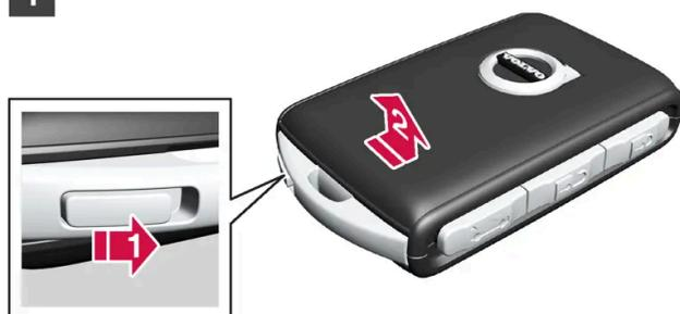
Pressione o bloqueio do suporte do porta-chaves para o lado e faça deslizar a tampa dianteira para fora do suporte.
