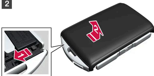
Desloque para o lado o bloqueio situado atrás da tampa dianteira e faça deslizar a tampa traseira para fora do suporte do porta-chaves.
