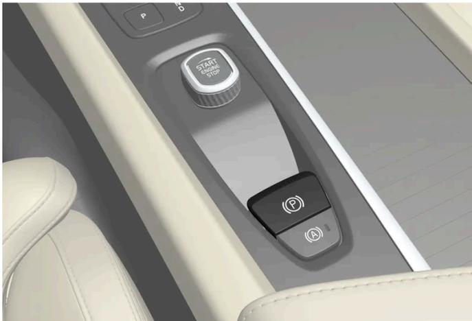
O comando do travão de estacionamento encontra-se situado na consola de túnel entre os bancos.
