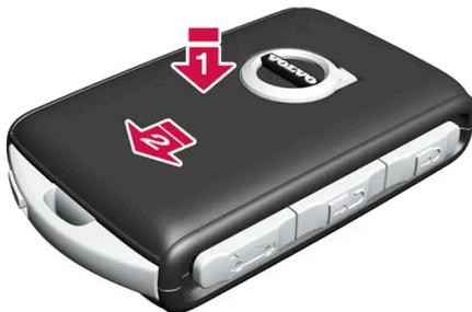
Volte a montar a tampa dianteira seguindo a ordem inversa de como foi solta. Prenda a tampa pressionando-a até ouvir um clique e faça-a deslizar nos últimos milímetros até à posição original.
