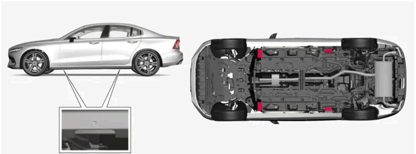
As setas ao longo da extremidade inferior na lateral do veículo indicam onde os suportes de macaco/pontos de levantamento (marcados em vermelho) se encontram localizados.
