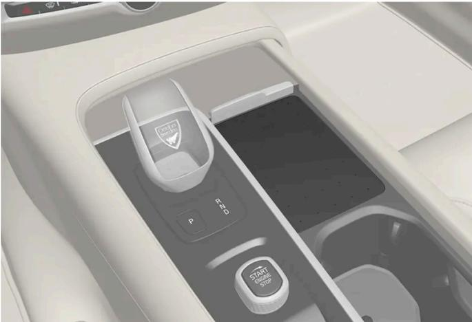
Carregador de telefone sem fios na consola de túnel.
