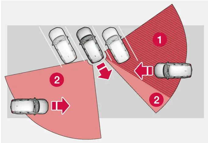
Num local de estacionamento inclinado os sensores podem ficar completamente bloqueados em relação a um lado.
