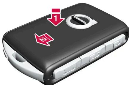
Vire a chave e volte a colocar a tampa dianteira da mesma forma que a traseira.
