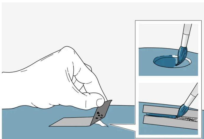
Se o dano não chegar ao metal a pintura de retoque pode ser aplicada diretamente após a limpeza da superfície.
