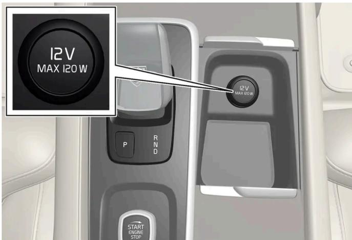
Tomada eléctrica dianteira da consola de túnel em automóvel sem carregador de telefone sem fios\*.
