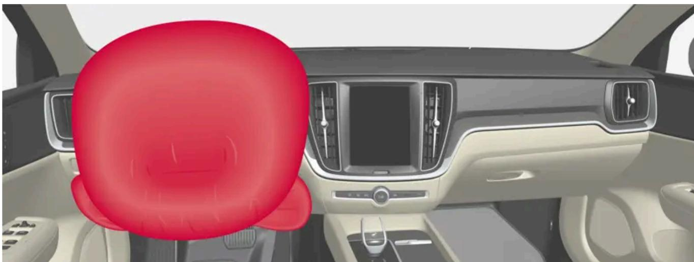
Airbag do volante e airbag do joelho<sup>[1]</sup> no lado do condutor no banco dianteiro.
