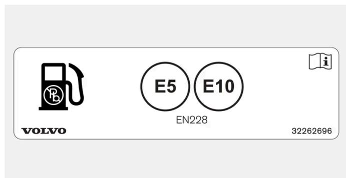
Autocolante no interior da tampa do depósito de combustível.
