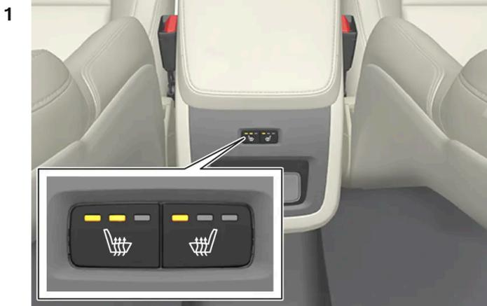
Botões para bancos traseiros com aquecimento elétrico na consola de túnel.
