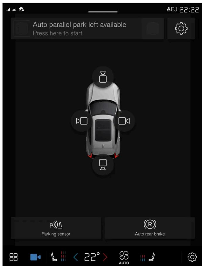
A vista de câmara mostra as câmaras de assistência de estacionamento (PAC<sup>[1]</sup>) que exibem uma vista composta de 360° e uma vista separada para cada uma das quatro câmaras: vista de câmara traseira, dianteira, esquerda ou direita.
