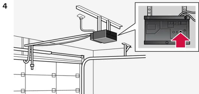
Procure o botão de memorização <sup>[2]</sup> no recetor, por ex.: porta da garagem. Normalmente encontra-se junto à fixação da antena no recetor.
