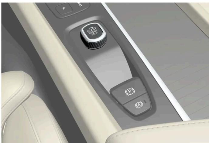
Disco de arranque na consola de túnel.
