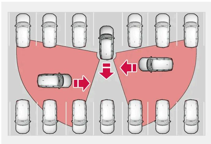
Exemplo de áreas onde a função pode ajudar o condutor a detetar obstáculos ao recuar.
