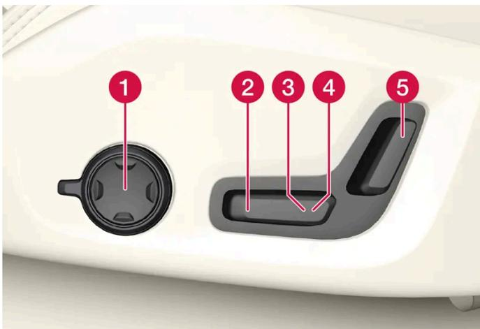
A imagem mostra o comando de um automóvel com apoio lombar de quatro vias\*. Automóveis com apoio lombar de duas vias\* não têm comando multifunções giratório.
