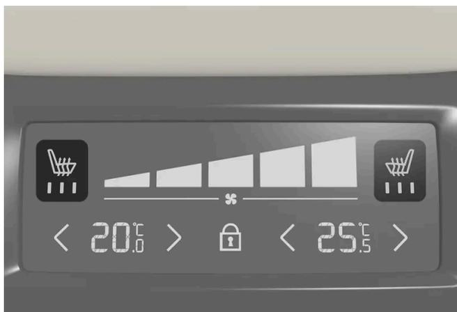
Indicação de aquecimento do banco e comando no painel de climatização traseiro na consola de túnel.
