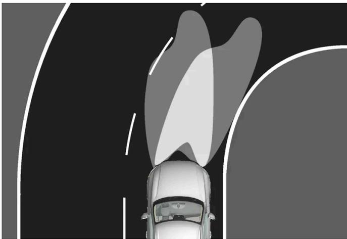
Foco dos faróis sem iluminação de curvas ativa (à esquerda) e com (à direita).
