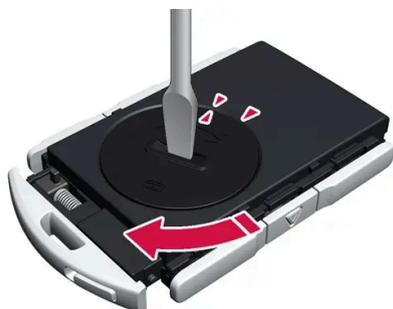
Volte a colocar a cobertura da bateria e gire-a no sentido dos ponteiros do relógio para a posição CLOSE.
