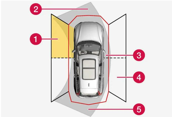
Sectores dos sensores de estacionamento onde se podem detetar obstáculos.
