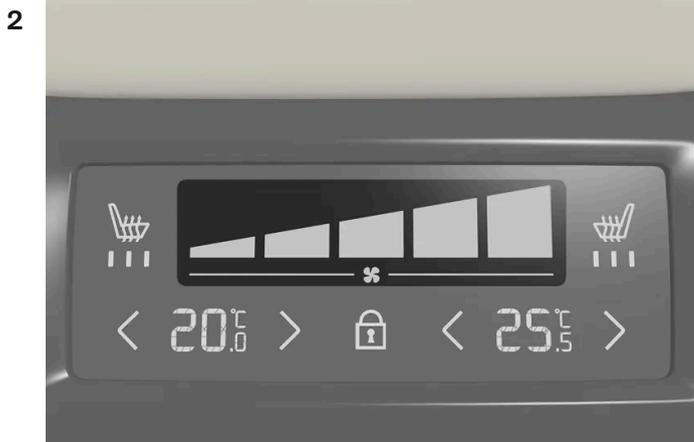
Comando do ventilador no painel de climatização traseiro na consola de túnel.
