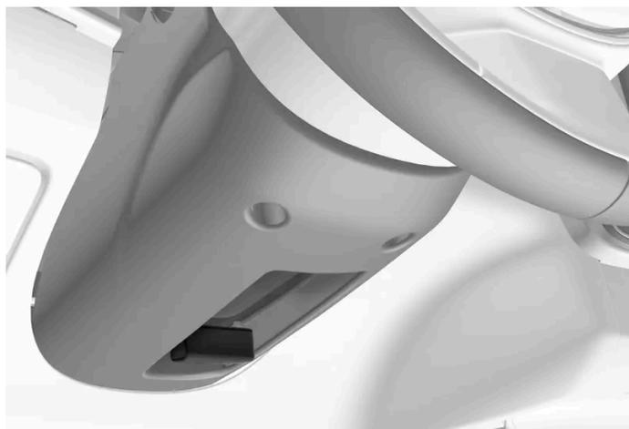
Alavanca para ajuste do volante.
