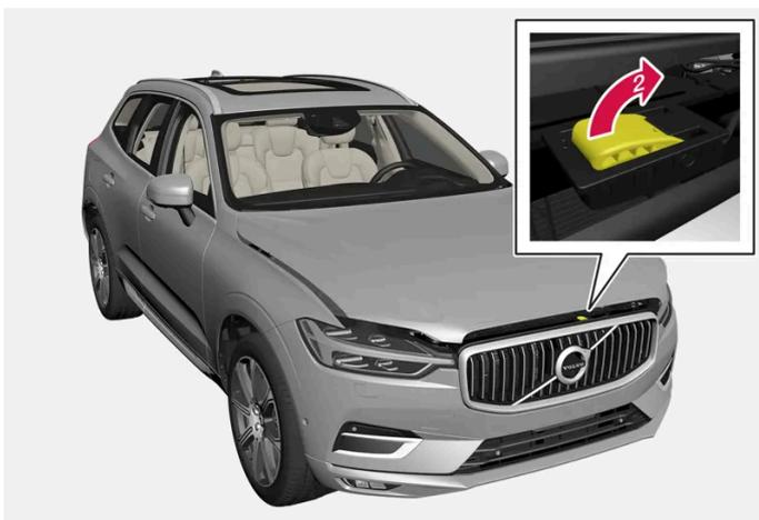
➔ Faça uma passagem da esquerda para a direita na abertura sob o capot, desloque a pega para cima e para o lado para libertar o fecho e levante o capot.
