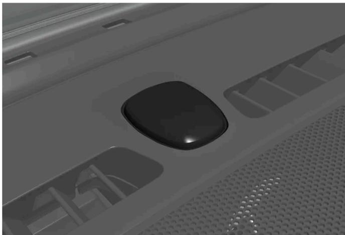
O indicador de trancagem e de alarme encontra-se no meio do painel de instrumentos, junto ao para-brisas.
