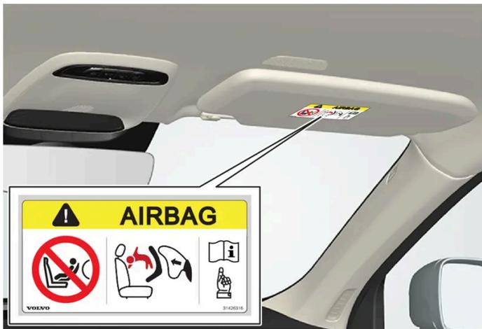
Autocolante na proteção solar do lado do passageiro.
