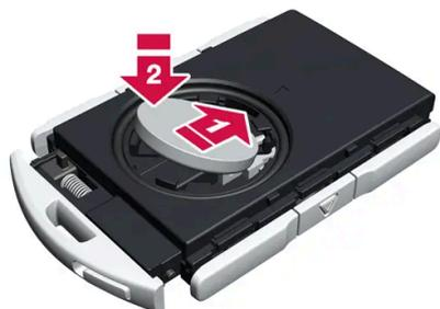
Coloque uma bateria nova com o lado (+) para cima. Evite tocar com os dedos nos contactos da bateria da chave.
