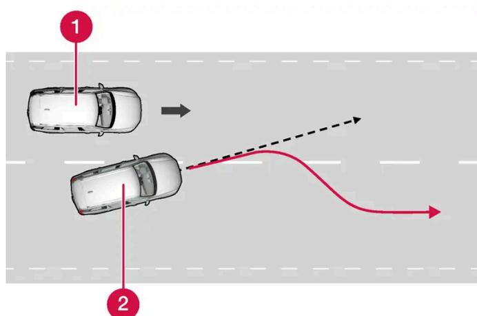
A função pode assistir dirigindo de volta para a sua faixa de rodagem.
