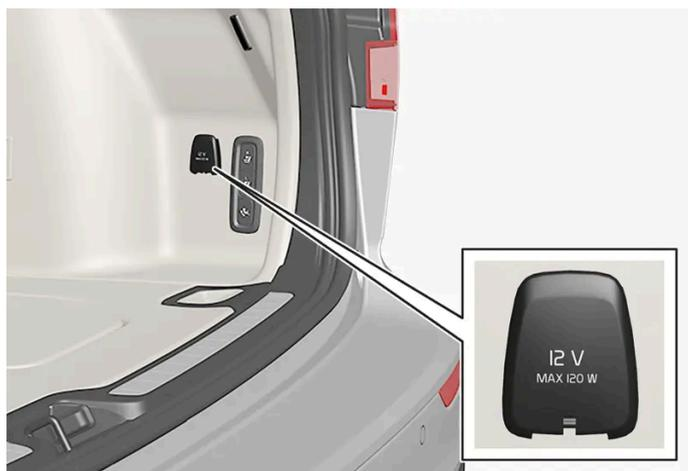
Tomada elétrica 12 V no compartimento da bagagem/carga\*.
