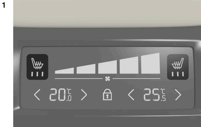
Indicação de aquecimento do banco e comando no painel de climatização traseiro na consola de túnel.
