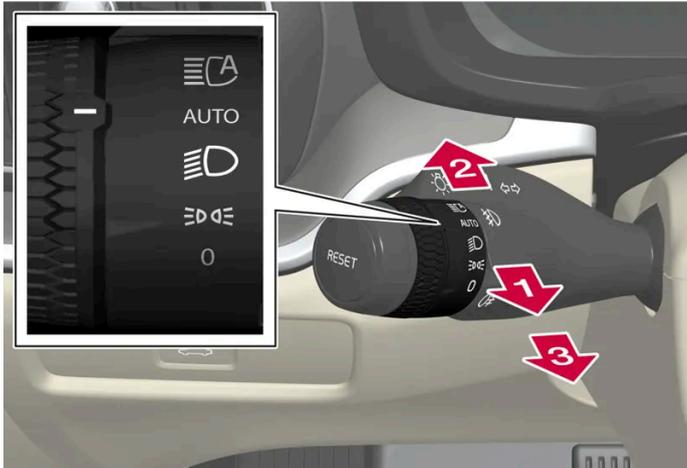
Alavanca do volante com anel rotativo.
