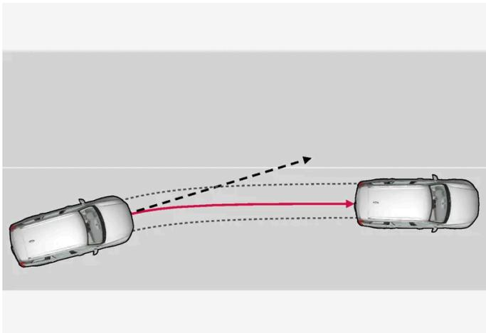
A assistência de faixa de rodagem dirige o automóvel de volta para a faixa de rodagem.
