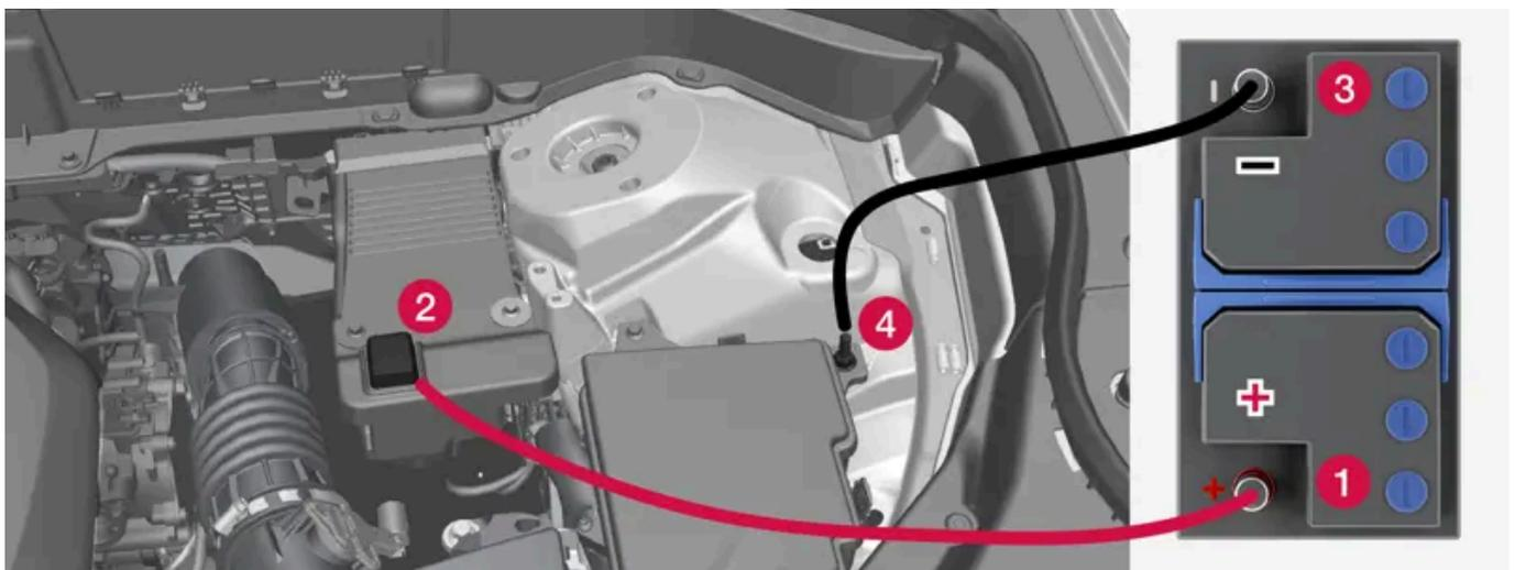
Pontos de carregamento para arranque assistido do automóvel. O aspeto do compartimento do motor pode variar com o modelo de automóvel e o nível de equipamentos.
