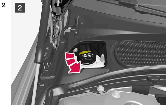
Desenrosque a tampa do tanque de expansão e encha com líquido de arrefecimento, se necessário. O nível deve estar entre as marcações de MIN e MAX no tanque de expansão.
