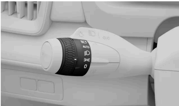
O símbolo das luzes de presença no anel rotativo na alavanca do lado esquerdo
