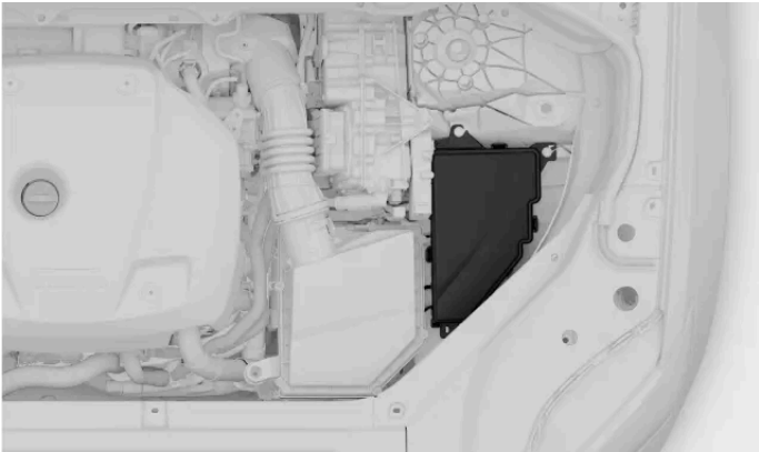
Localização da caixa de fusíveis
