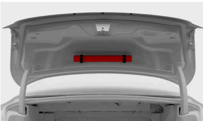
O triângulo de sinalização de perigo encontra-se preso por dois cliques no interior da tampa do porta-bagagens.
