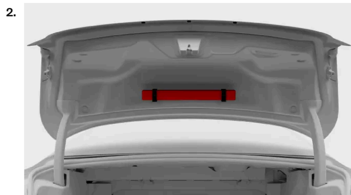
O triângulo de sinalização de perigo encontra-se preso por dois cliques no interior da tampa do porta-bagagens.
