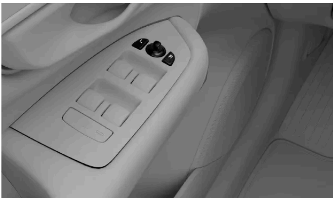
Comandos para ajuste dos retrovisores laterais
