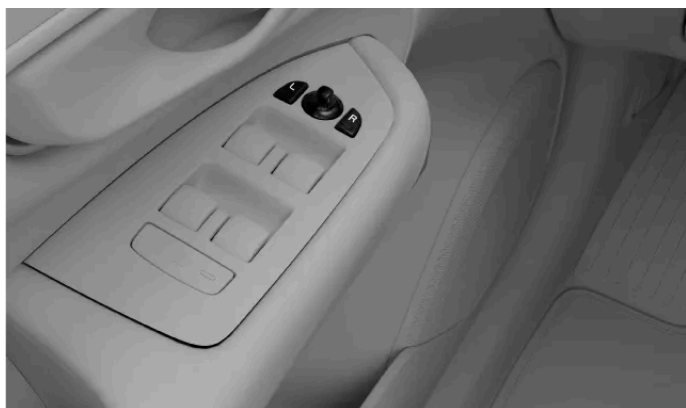
Comandos para ajuste dos retrovisores laterais
