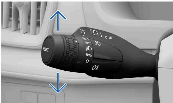
Os indicadores na alavanca do lado esquerdo
