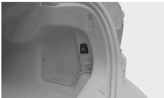
A toma elétrica de 12 V encontra-se no lado esquerdo do porta-bagagens
