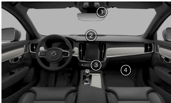
Os sensores da climatização interior
