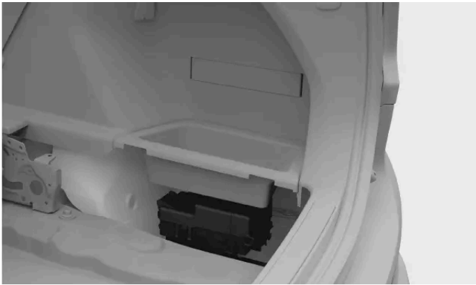
Localização da caixa de fusíveis
