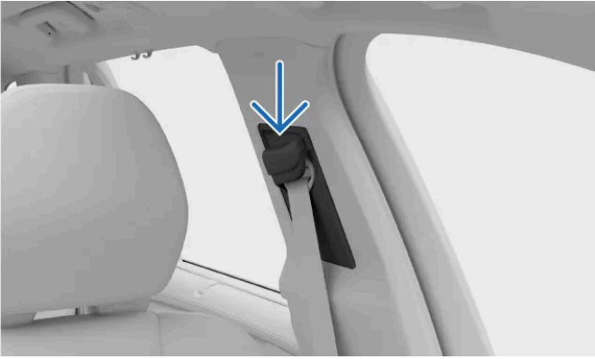
Ponto de fixação superior do cinto de segurança
