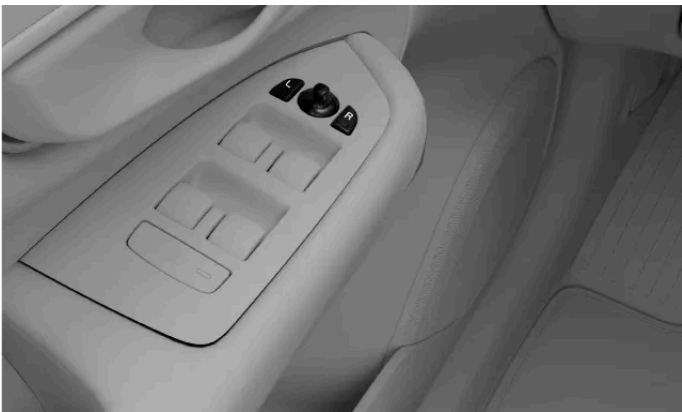
Comandos para ajuste dos retrovisores laterais
