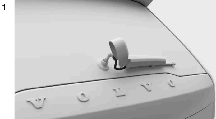
Procura a cobertura de plástico onde o braço do limpa-para-brisa prende ao automóvel. Solte primeiro o lado da cobertura mais próximo de si, e depois o lado mais afastado. Levante completamente a cobertura de plástico. Isto permite-lhe o acesso a um conector de mangueira.
