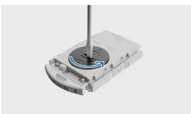
Utilizando uma ferramenta adequada, como uma chave de fendas ou uma moeda, rode a tampa da pilha no sentido contrário ao dos ponteiros do relógio para a libertar.
