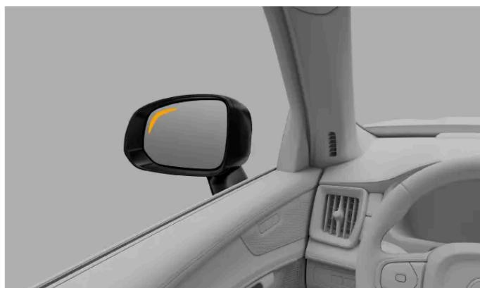
Quando um veículo é detetado ou se aproxima do seu ponto morto, aparece uma luz no retrovisor lateral.
