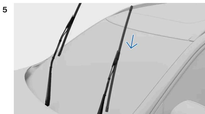
Assegure-se de que a escova do lado do condutor é mais comprida do que a do lado do passageiro. Deslize a escova do limpador de para-brisa no braço do limpador de para-brisa. Assegure-se de que o pino no braço do limpador de para-brisa entra no orifício da escova do limpador de para-brisa. Empurre a escova no braço do limpador de para-brisa até escutar um estalido.
