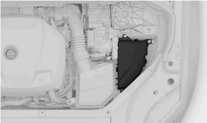
Localização da caixa de fusíveis
