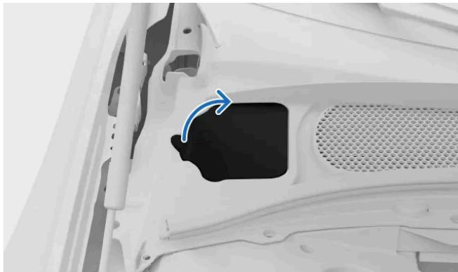
Abra a portinhola do painel no canto superior esquerdo do compartimento do motor para aceder ao reservatório do líquido de arrefecimento.
