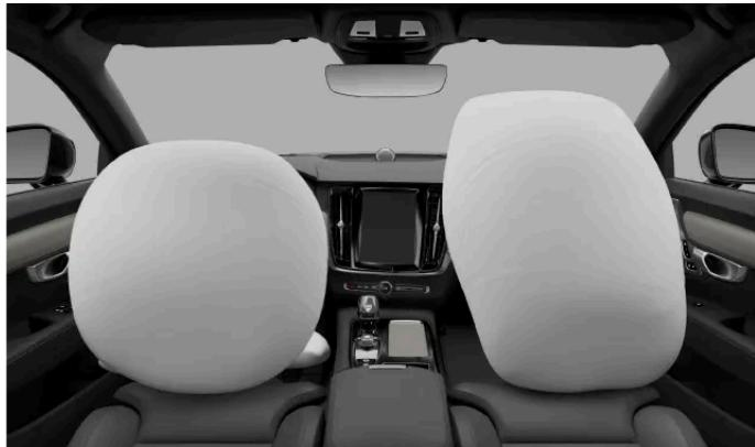
O lado do condutor e o lado do passageiro têm um airbag frontal cada. O airbag do lado do condutor está acondicionado no volante e o airbag do lado do passageiro está acondicionado no painel acima do porta-luvas.
