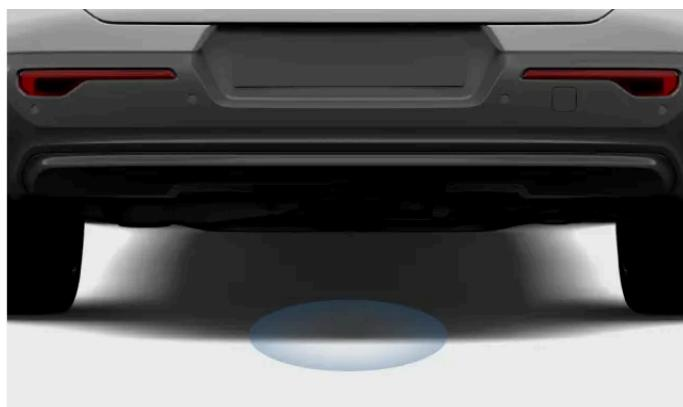
O sensor deteta movimentos sob o para-choques-traseiro. Qualquer movimento detetado destranca o porta-bagagens.
