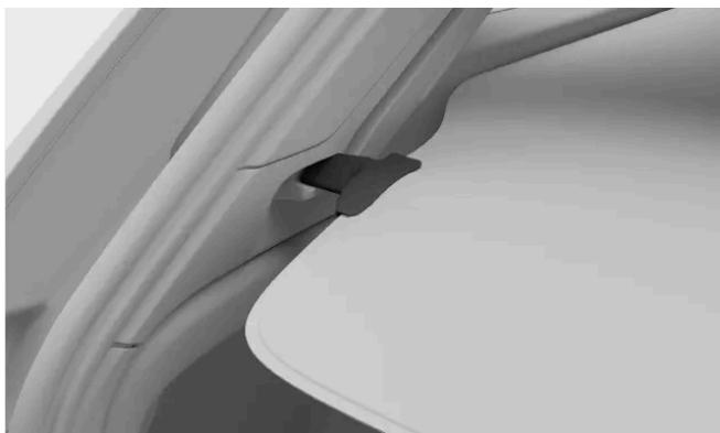
Levante e puxe a extremidade da tela da cobertura de carga pela pega para a desbloquear. Isto permite a retração da tela de carga.
