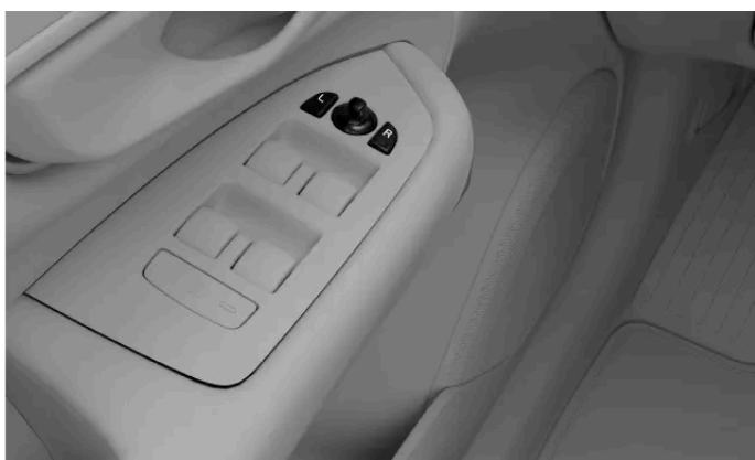
Comandos para ajuste dos retrovisores laterais
