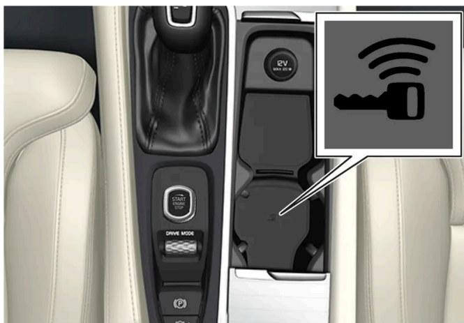
Localização do leitor de recurso na consola de túnel.
