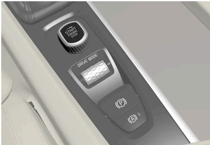
Disco de arranque na consola de túnel.
