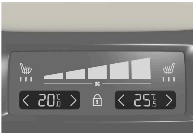
Comando da temperatura no painel de climatização traseiro na consola de túnel.
