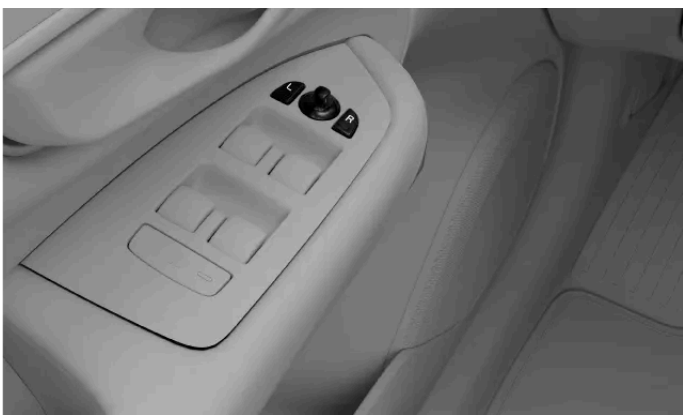
Comandos para ajuste dos retrovisores laterais
