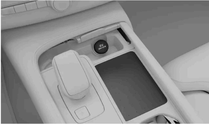
A tomada de 12 V na consola de túnel
