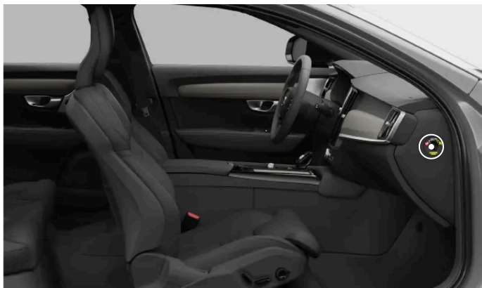
Localização do interruptor do airbag do passageiro
